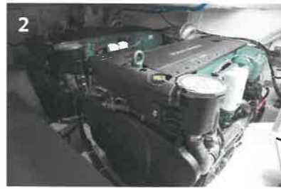
1 Ein Maschinenraum, der sich auch so nennen darf! 2 Die beiden Volvo-Motoren bringen jeweils 380 PS Leistung ins Wasser - optional auch 440 PS mit dem IPS-Antrieb
