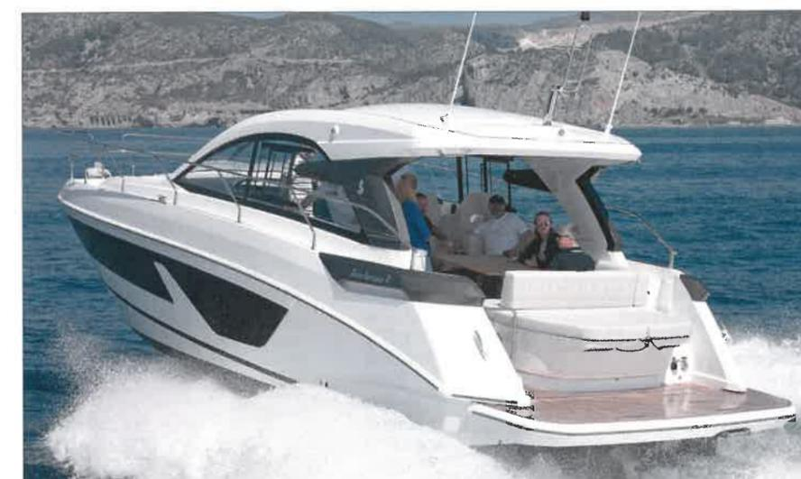
La paire de 380 ch montée sur embases se montre peut gourmande à 20 nœuds avec une conso horaire sous les 70 litres.
