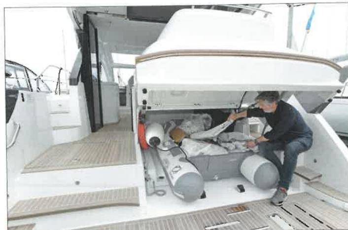
Le garage à annexe est suffisamment vaste pour abriter un pneumatique de 2,30 m de longueur. Il est possible d'accéder aux moteurs depuis le plancher.
