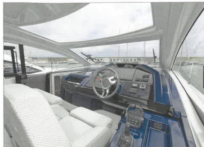
Le tableau de bord au design très travaillé est rigoureusement identique à celui de l'ex-GT46. Les commandes de gaz et le joystick de manœuvre qui repose sur une platine s'avèrent bien positionnés.
