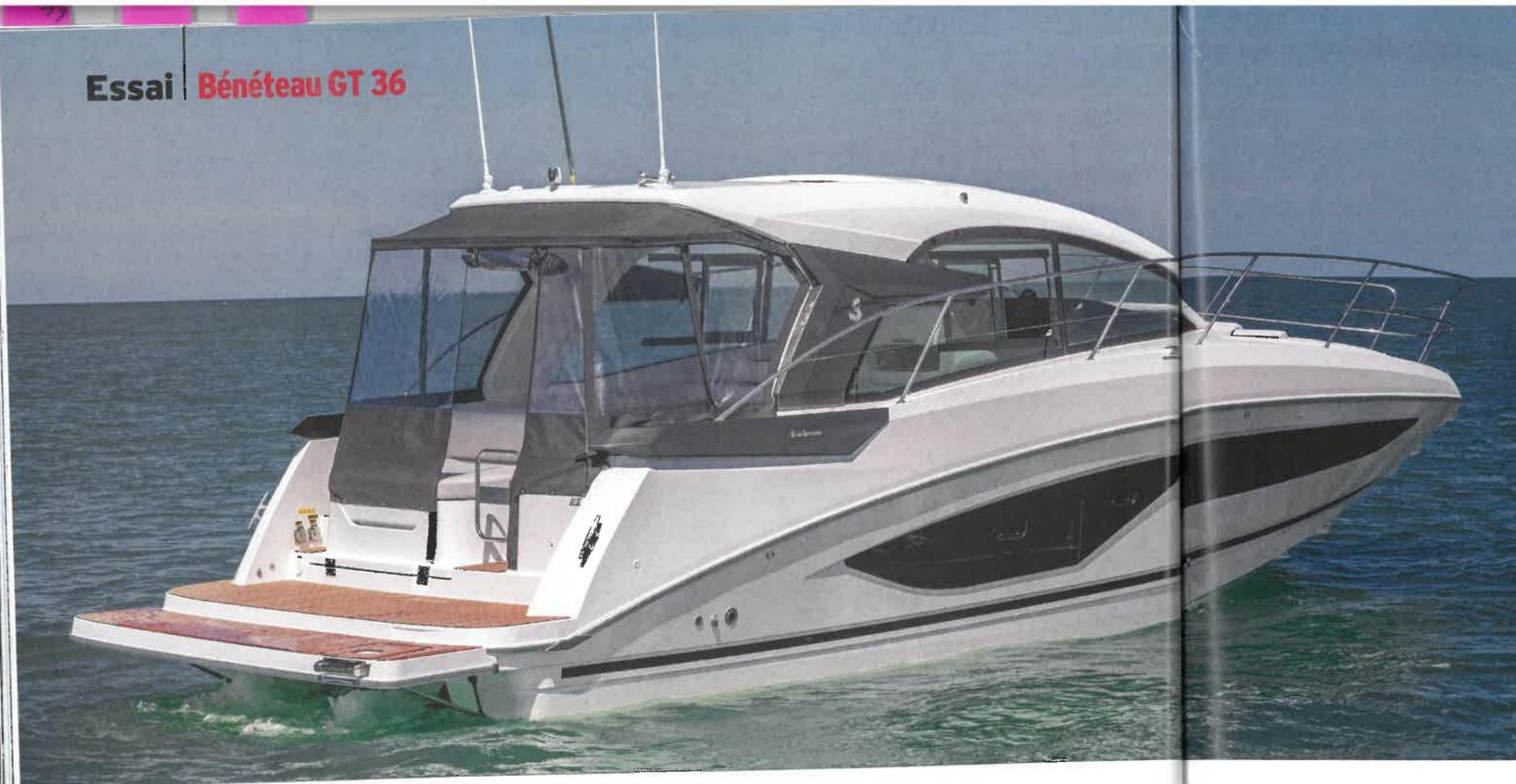
Le bain de soleil arrière abrite la cale moteur. Nous avons essayé la version inboard la plus puissante avec deux Volvo D4 de 300 chevaux.
