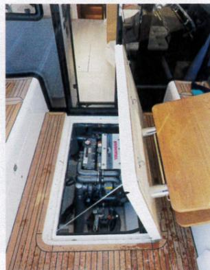
Der Yanmar-Motor ist über eine große Klappe von oben aus dem Cockpit zugänglich
